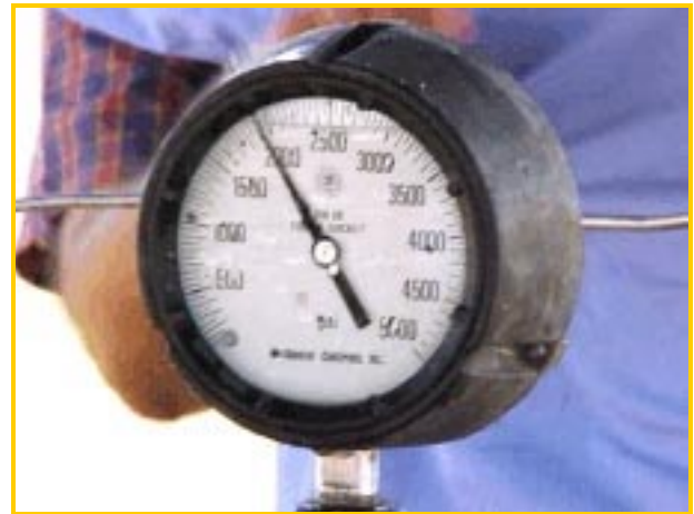
Figura No. 16 - 2,000 psi Presión de Falla
